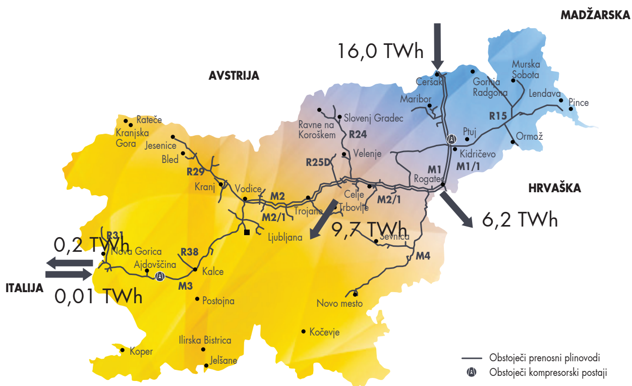
SLIKA 100: PRENOSNI SISTEM ZEMELJSKEGA PLINA IN PRENESENE KOLIČINE ZEMELJSKEGA PLINA NA VSTOPNIH IN IZSTOPNIH TOČKAH
